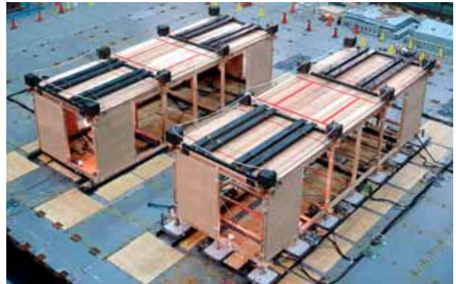
図12 震動台上に設置された標準試験体2棟 (左：土台仕様、右：足固め仕様)
