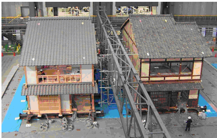
図7 京町家2棟の震動台実験 (左：新築京町家試験体、右：移築京町家試験体)
