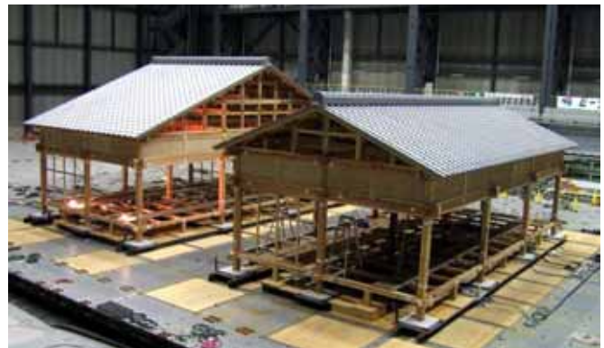
図13 震動台上に設置された切妻屋根試験体2棟 (左：長辺折りL試験体、右：短辺おりS試験体)
