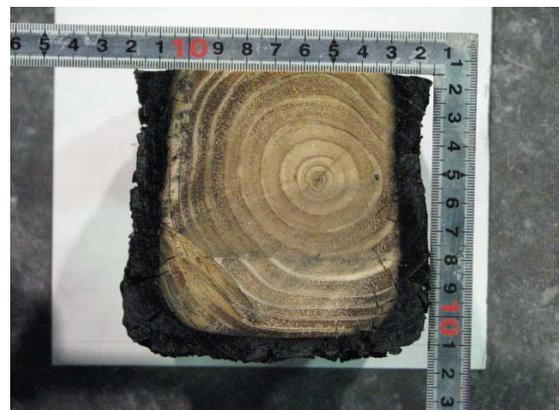
写真12 木材試験体(120mm角)の炭化状況(断面)
